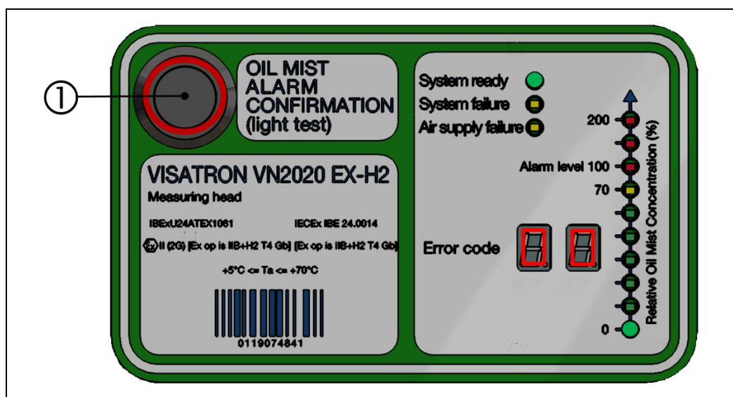
Abb.: 57 :Messaufsatz VN2020 EX-H2: LED- Check (Leuchtestest)
