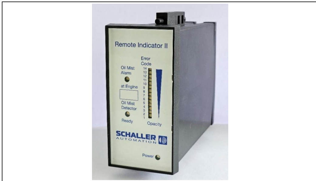
Abb.: 13 : Fernüberwachungssystem (Remote Indicator II) für VISATRON®- Systeme (optional)
