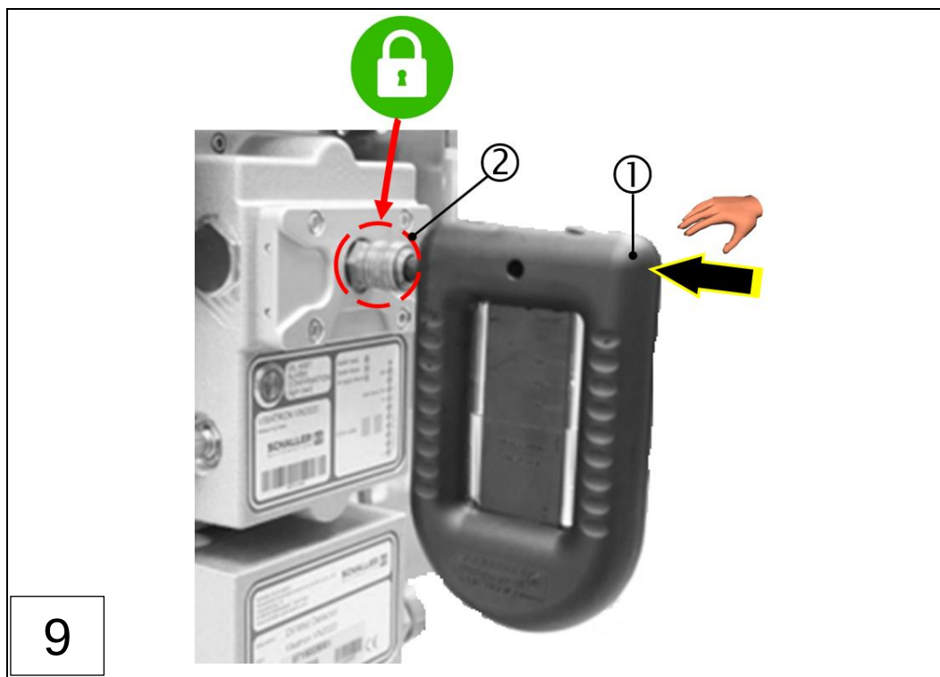
Abb.: 71 : Messaufsatz VN2020 EX-H2 austauschen, (Schritte 1 - 9)
