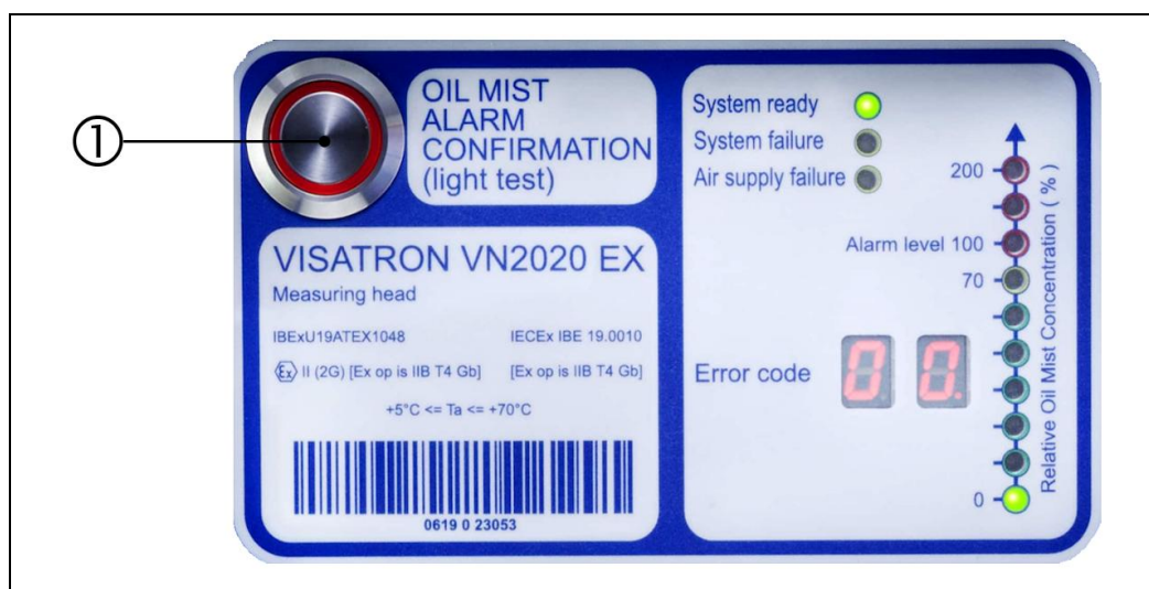
Abb.: 70 :Messaufsatz VN2020: LED- Check (Leuchtestest)
