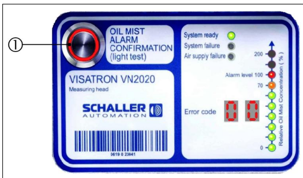
Abb.: 73 :Messaufsatz VN2020: Ölnebelalarm bestätigen
