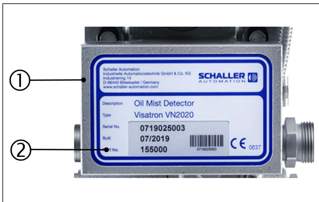
Abb.: 5 : Typenschild, Anschlusskasten VISATRON® VN2020
