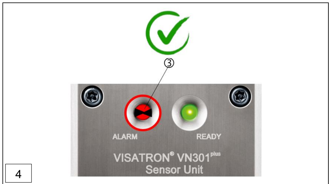
图：84：使用烟管进行功能测试（油雾测试，步骤 1-4）
