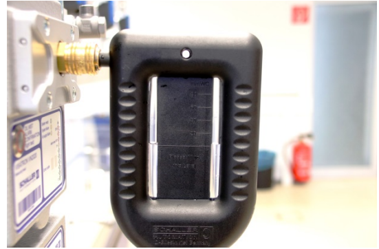
插图 59 : U 形管压力计上负压的显示
