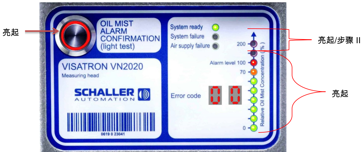
插图 62：带有报警的 LED 显示屏示例显示
