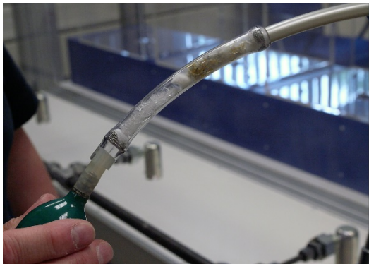
插图 78 : 拆除烟管和泵
