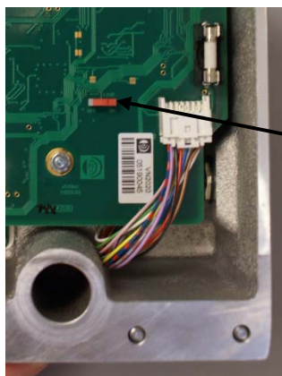
插图 51 : 可以开关的终端电阻
