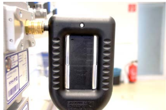
插图 149 : 检查盖上的 U 形压力计
