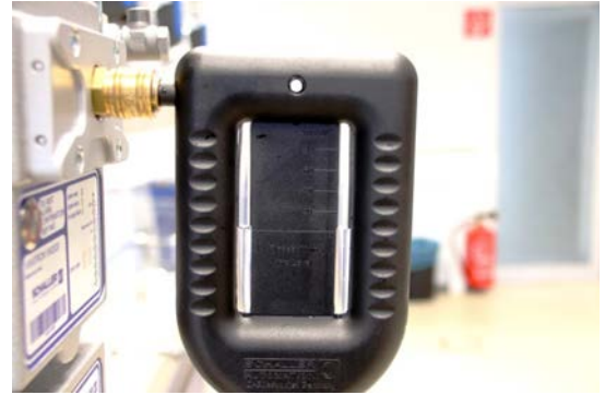
插图 113 : 在测量附件上设置负压
