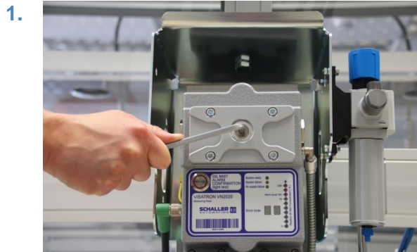
插图 54：带螺旋塞的检查盖
