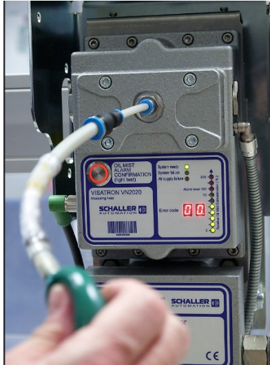
插图 76 : 将烟气泵送入 MAS 中
