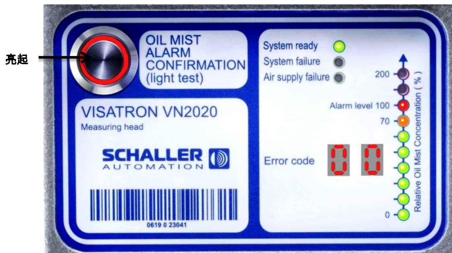
插图 61：显示屏和探测到的油雾
