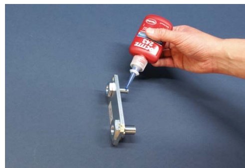
插图 24 : 螺栓和 Loctite 243
