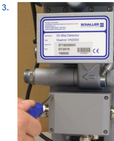
插图 117 : 拆卸盖子
