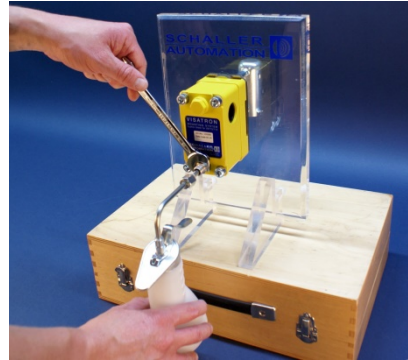
插图 32：安装加注泵
