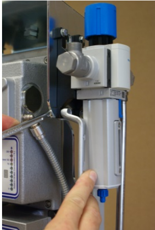
插图 130 : 拆卸过滤器调节阀
