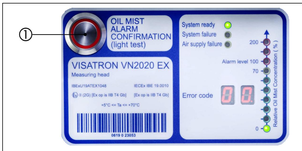
图: 70： 测量附件 VN2020：LED 检查（指示灯测试）
