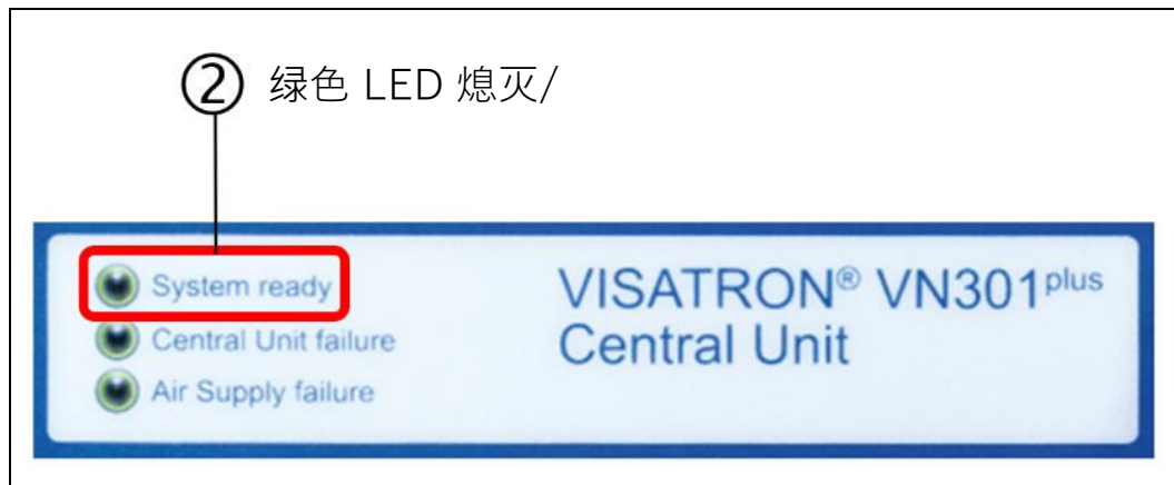
图：104： VN301 plus 中央单元：“System Ready” LED 状态指示器
