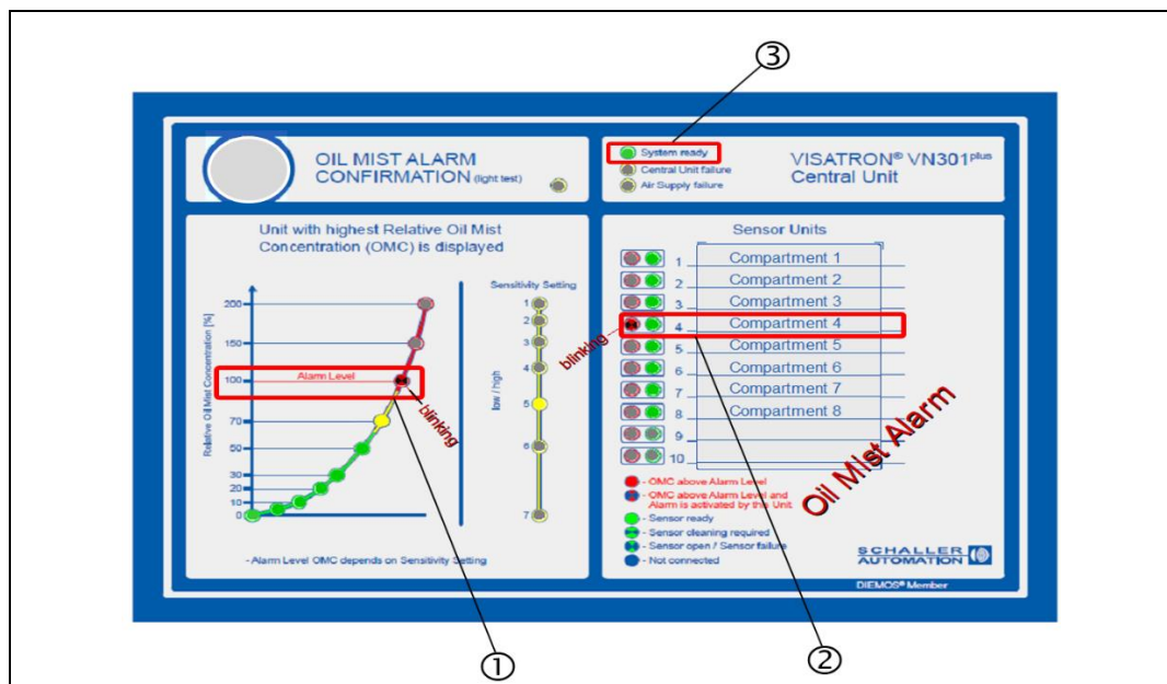
图：85：VN301plus 中央单元：100% OMC 时的“报警”状态显示（示例 1）
