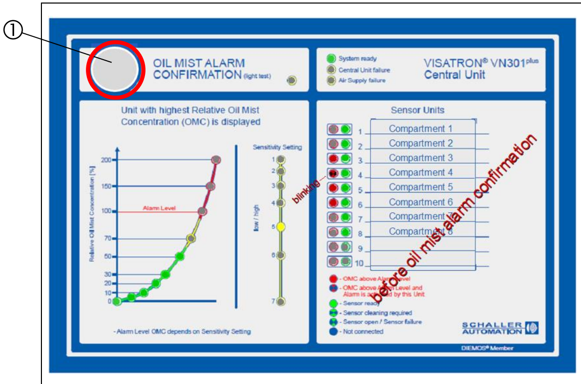
图：88：VN301 plus 中央单元：50% OMC 时的“报警”状态显示（示例）
