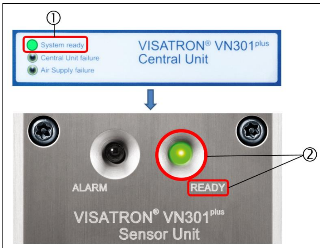
图：73：VN301 plus /VN301 plus EX 中央单元和传感器单元上的“System Ready”
