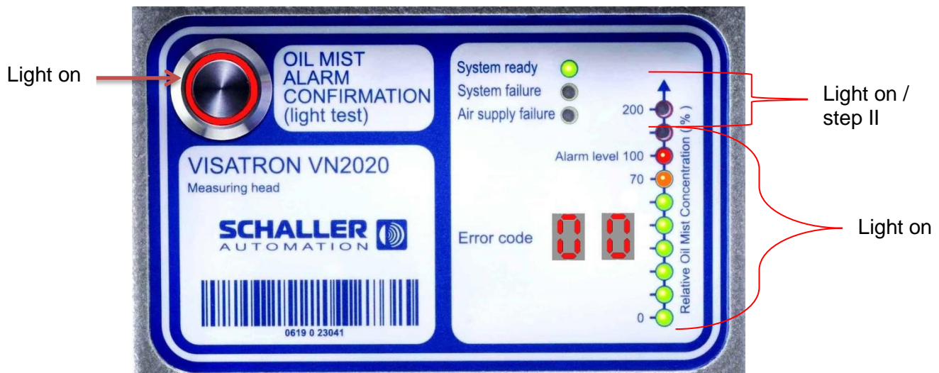
Figure 62: Beispielanzeige LED Display mit Alarm
