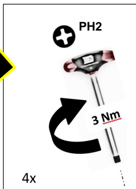
Fig.: 80 : Close the VN301 plus central unit (steps 1 - 4)
